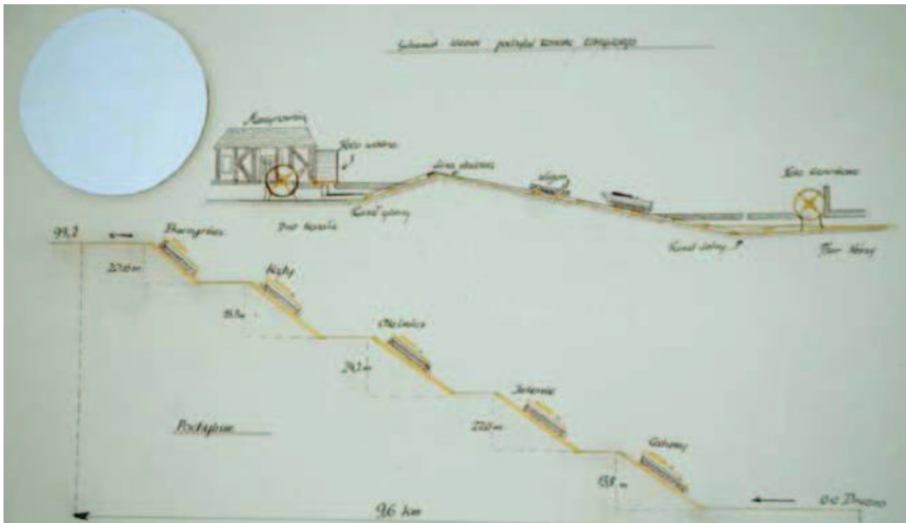
Rys. 11. Koncepcja „przenoszenia” statków i barek wg pomysłu inż. J. Steenke
