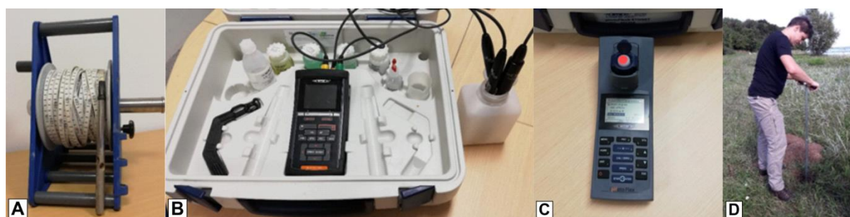
Rys.3.1. Wykorzystany sprzęt pomiarowy i narzędzia badawcze: A – elektroniczny sygnalizator dźwiękowo-światlny do pomiaru położenia zwierciadła wód podziemnych; B – miernik wieloparametrowy Multi 3630 IDS wraz z elektrodami; C – fotometr filtrowy pHotoFlex STD; D – wykonanie sond badawczych przy użyciu sprzętu wiertniczego firmy Eijkelkamp.
