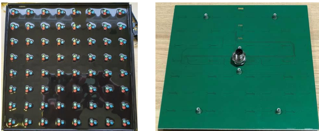
Rys. 49. Panel wyświetlacza IZD, rozdzielczość 8 x 8 pikseli RGB.
