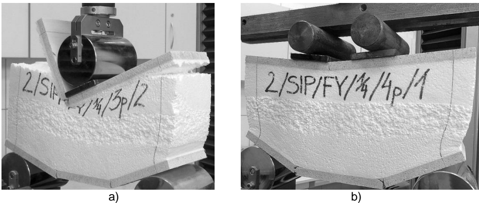
Rysunek 2.49. Mechanizm zniszczenia belek CSIP poddanych zginaniu przy rozstawie podpór L_0 = 275 mm; a) trójpunktowe zginanie; b) czteropunktowe zginanie
