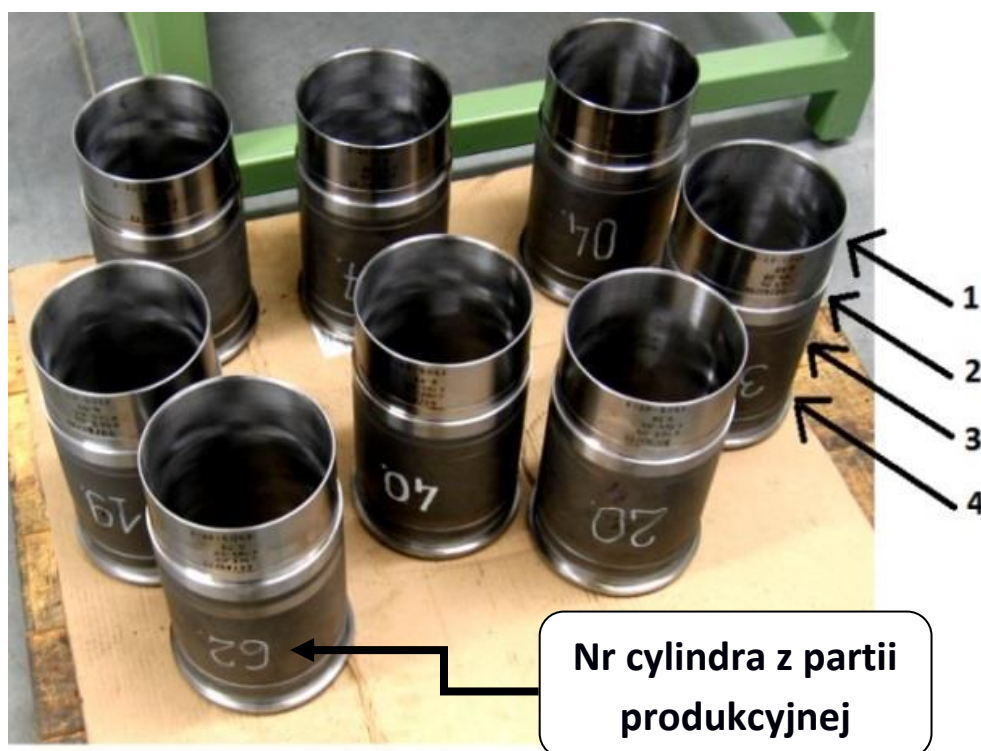
Rys. 119. Miejsca wykonywania pomiarów średnicy i odchyłki kształtu walcowości gładzonej tulei o zmiennej grubości ścianki (grubość g_1 < g_3 < g_2 < g_4 )
