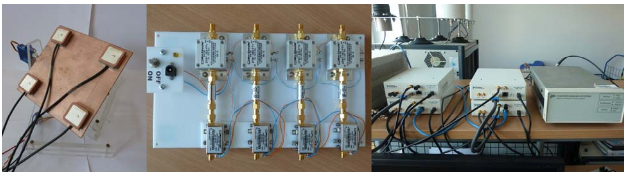
Rys.3. Platforma sprzętowa demonstratora systemu antyspoofingowego (szyk antenowy, tory w.cz., urządzenia USRP i wzorzec rubidowy)
