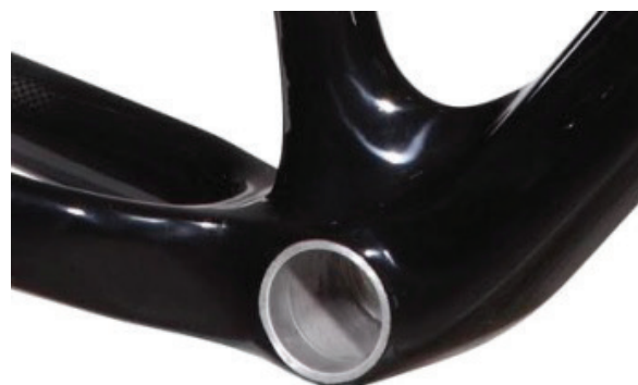
Rys. 3. Węzeł konstrukcyjny wykonany z materiału kompozytowego [6]
