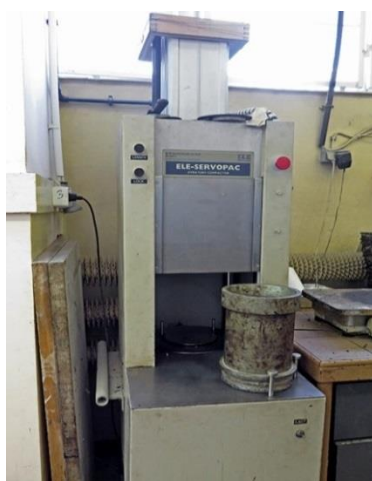
Rysunek 4.12. Prasa żyratorowa i zasada jej działania
