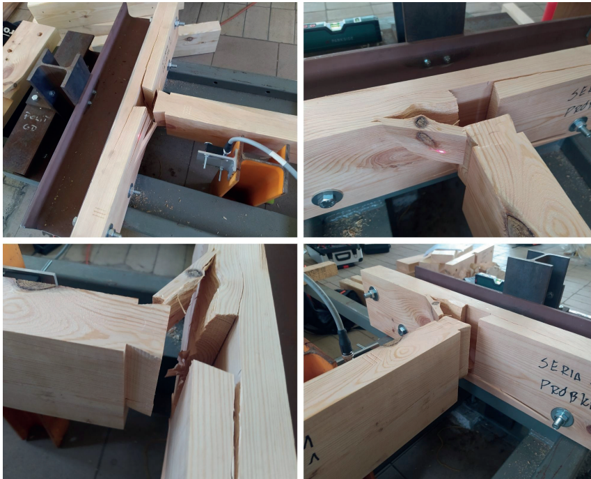
Fot. 3. Przykłady uszkodzeń próbek; źródło: opracowanie własne
