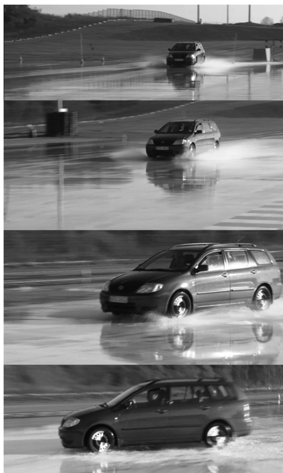
Fot. 5. Zablokowane koła samochodu – hamowanie bez ABS
