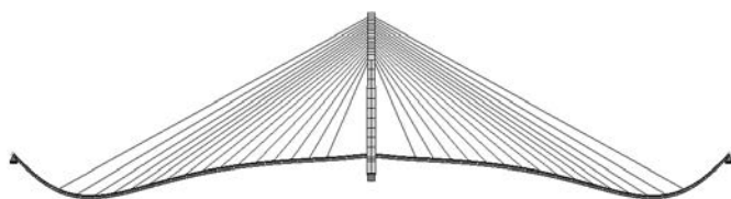
Rys. 6. Przesunięcia pomostu przed i po naciągu want
