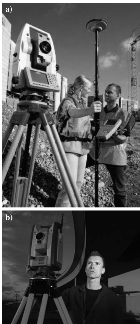
Rys. 1. Zastosowanie zestawu GPS i tachimetru na budowie (a) [7] oraz w budownictwie drogowym (b) [10]
