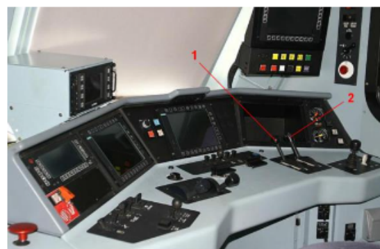
Rys. 5. Pulpit maszynisty lokomotywy Siemens serii 189: 1- nastawnik hamulca pneumatycznego, 2- nastawnik hamulca elektrodynamicznego. [16]
