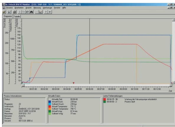
Rys. 6. Zapis komputerowy sterowania procesem spiekania wyrobu z proszkiem DIABASE V21 oferowanym przez firmę Dr. Fritsch. Linie koloru: czerwonego - temperatura, niebieskiego - ciśnienie, zielonego – odległość tłoków prasujących [2, 23]
