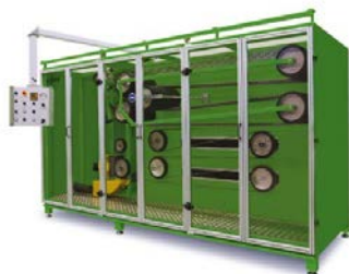
Rys. 8. Automaty do obróbki końcowej (oczyszczanie, otwieranie powierzchni diamentowej, nadawanie wymaganych wymiarów) obróbki: a) pił tarczowych, b) pił linowych [2]
