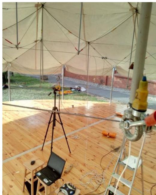
Rys. 68 Punkty wzbudzenia oraz rejestrowania przyspieszeń w badaniu dynamicznym namiotu o powierzchni 160 m 2 .
