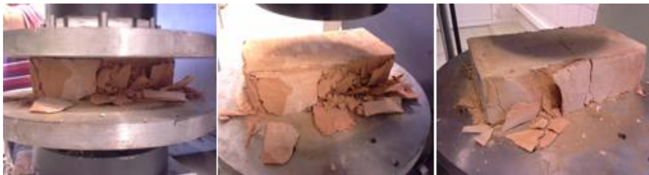
Rys. 43 Badanie cegieł pełnych
