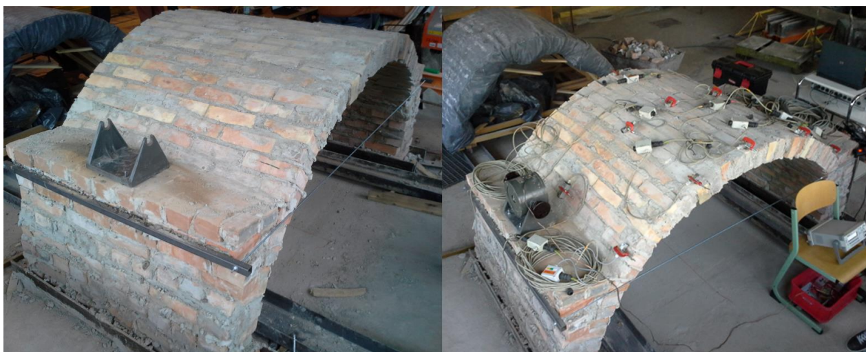
Rys. 47 Sklepienie przed i w trakcie badań
