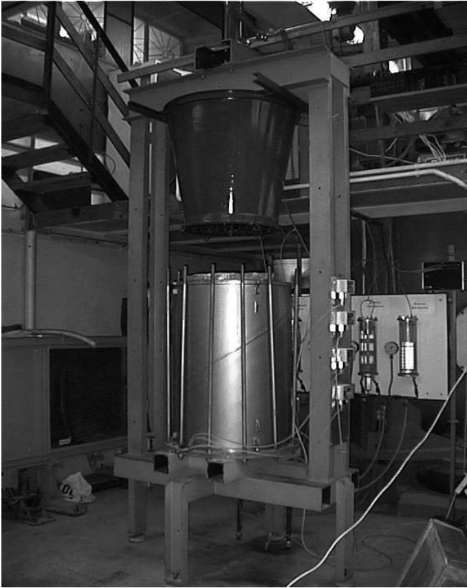
Rys. 2. Widok stanowiska badawczego z wsuniętym lejem zasypowym [5]
