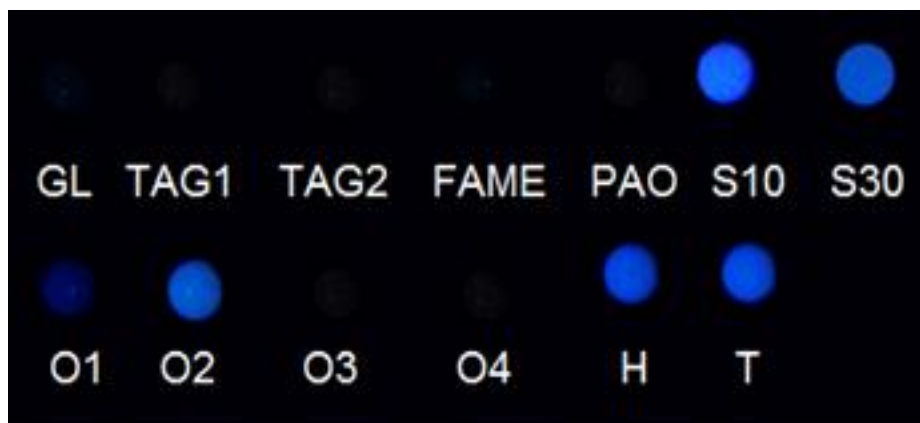
Rysunek 8. Zestawienie fotografii dla próbek nałożonych na czarną, matową płytkę, umieszczone w zaciemnionym miejscu i oświetlone lampą typu LED UV \lambda = 365 \text{ nm} ; Próbki kolejno: GL-gliceryna bezwodna; TAG1- olej słonecznikowy; TAG2- olej rzepakowy; FAME- FAME techniczne; PAO-olejowa baza syntetyczna typu polialfaolefinowego; S10- mineralna baza olejowa SAE 10/90; S30- mineralna baza olejowa SAE 30/90; O1-olej do smarowania układu tnącego produkowanego z mieszaniny bazy roślinnej oraz mineralnej z dodatkami uszlachetniającymi; O2- olej maszynowy, mineralny; O3- olej do smarowania układu tnącego produkowanego na bazie roślinnej z dodatkami uszlachetniającymi; O4- frytura; H- olej hydrauliczny; T- olej turbinowy
