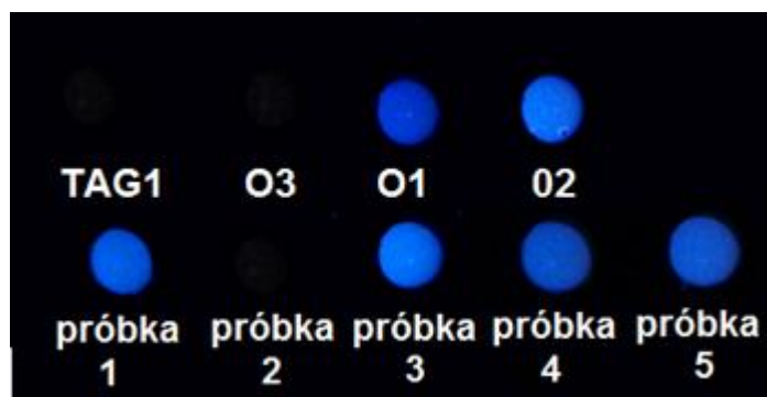
Rysunek Z4-1. Fotografia zestawienia wyników badań dla olejów referencyjnych i badanych próbek w świetle \lambda = 365 \text{ nm}
