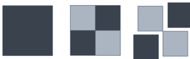
Rysunek 16. Schemat kwartowania odpadów komunalnych (wg PN-93-Z15006)
