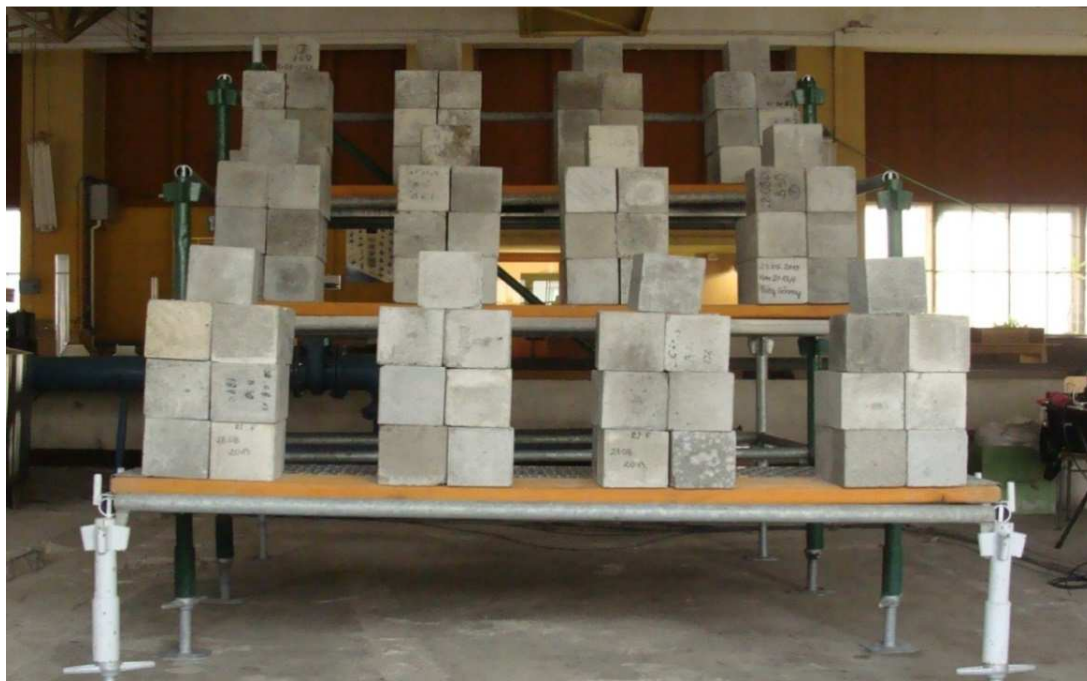
Fot. 5.4 Obciążona tymczasowa trybuna stalowa (widok z przodu).
