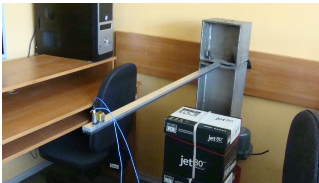
Fot. 4.2 Aluminiowa belka wspornikowa z podklejoną od dołu warstwą polimeru.
