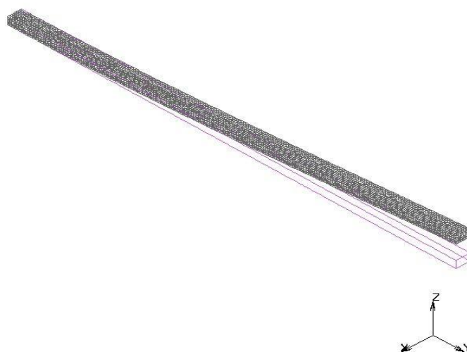
Rys. 4.82 Pierwsza postać poprzeczna drgań własnych aluminiowej belki wspornikowej z warstwą polimeru.
