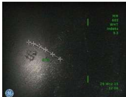
d) Pomiar długości wielosegmentowej (łamanej) rysy denku tłoka wykonany metodą „Cienia” - 5,42 mm z indeksem dokładności 5.3 odpowiadającemu błędowi bezwzględnemu rzędu 0,25 mm
