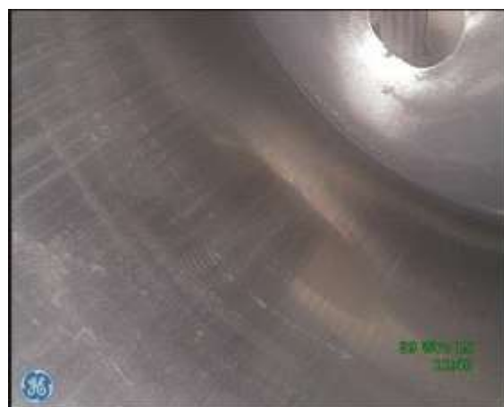
f) Gładz cylindrowa w rejonie GMP - ślady zużycia ściernego, brak śladów "honowania" tulei
