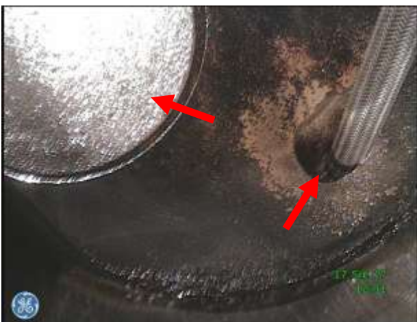
e) Dolna płyta głowicy, zawór dolotowy – sonda inspekcyjna wprowadzona przez otwór po zdemontowanym wtryskiwaczu
