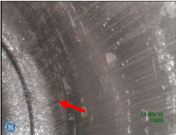
a) Gładź cylindrowa w rejonie DMP - ślady zużycia ściernego, brak śladów "honowania" tulei
