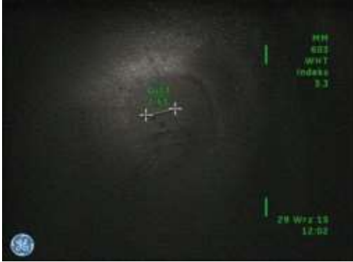
a) Pomiar długości cyfry na denku tłoka wykonany metodą „Cienia” - 2,53 mm z indeksem dokładności 3.3, co daje błąd bezwzględny rzędu 0,7 mm
