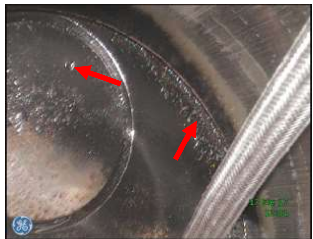
f) Dolna płyta głowicy, zawór wylotowy – nieznaczne osady zanieczyszczeń, nieznaczne wgniecenie na powierzchni grzybka zaworowego
