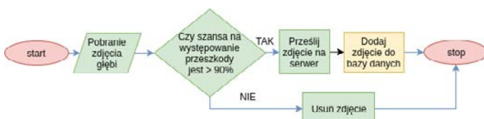
Rys. 4. Przepływ zdjęć głębie przez system: na zielono – elementy znajdujące się w aplikacji klienckiej, na żółto – elementy aplikacji serwerowej
