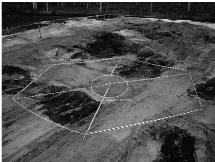
Rys. 4. Kolumna badana w otoczeniu sześciu kolumn wzmocniających
