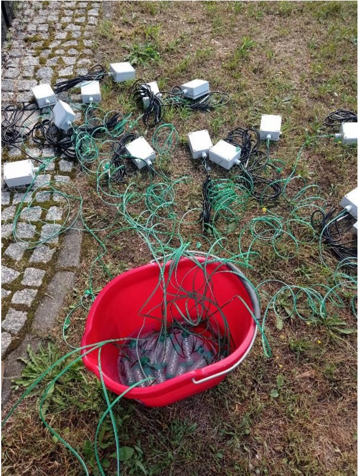
Rysunek 38. Przygotowanie sond wilgotności zgodnie z instrukcją producenta
