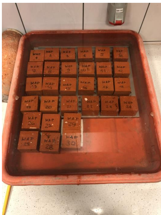
Rys. 10 Próbkki sześciennie cegieł przygotowane do badań wytrzymałości na ściskanie wg PN-EN 772-1 [N7] (fot. Tomasz Majewski)
