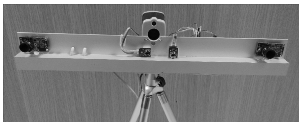
Rys. 4. Urządzenie do pomiaru odległości i temperatury
