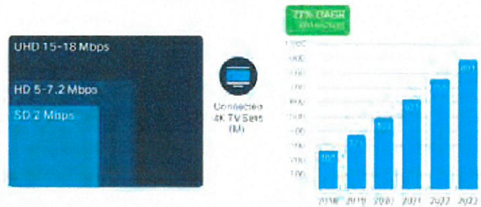
» Rys. 2. Zależność pomiędzy jakością przekazu TV 4K, a wymaganiami pasma (szybkość transmisji). Zmiany liczby urządzeń TV standardu 4K (Źródło: [1])
