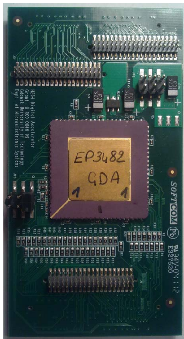
Rys.2. Fotografia płytki prototypowej z zamontowanym układem ASIC akceleratora estymacji ruchu
