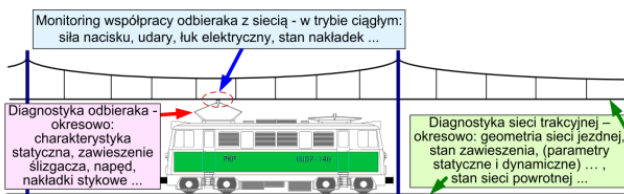
Rys. 1. Stan diagnostyki systemu odbioru prądu
