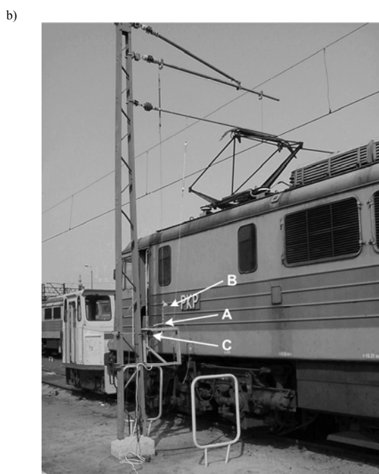
Rys. 4. Terenowe stanowisko pomiarowe: a) szkic konstrukcyjny, b) widok stanowiska; A – żyroskopowy czujnik prędkości, B – czujnik przyspieszeń, C – wzbudnik drgań
