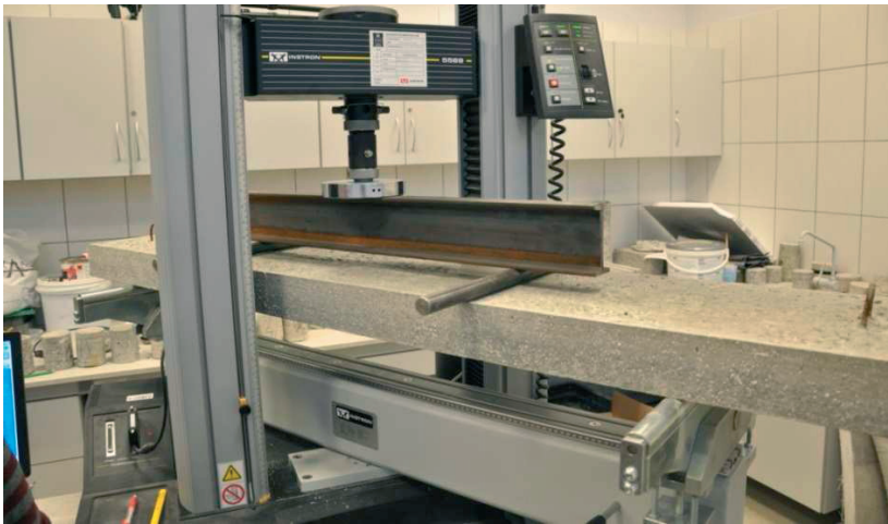
Rys. 5. Próbką żelbetową w trakcie próby niszczącej
