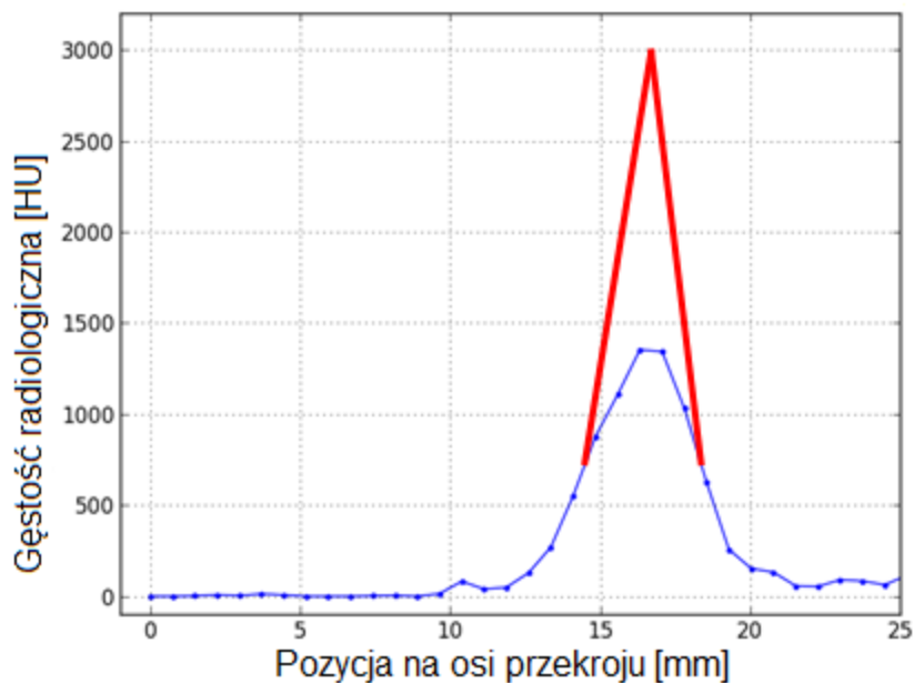
Rys. 5.3 Niebieska linia – gęstość radiologiczna przekroju zdjęcia TK w przekątnej próbki zaznaczonej na Rys. 5.2. Czerwona linia – gęstość radiologiczna wirtualnej próbki. (opracowanie własne).
