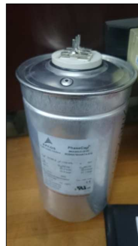
Rys. 7. Uszkodzony kondensator 25kVAr
