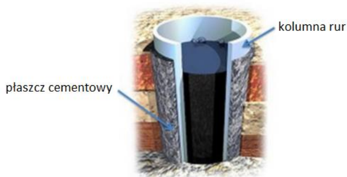
Rysunek 12 Wizualizacja płaszczu cementowego [23]
