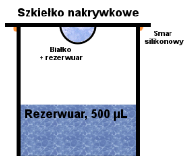
Rys. 58 Schemat krystalizacji białka metodą kropli wiszącej
