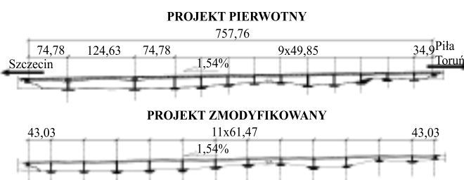
Rys. 2. Porównanie pierwotnej i zrealizowanej wersji projektu w profilu podłużnym
