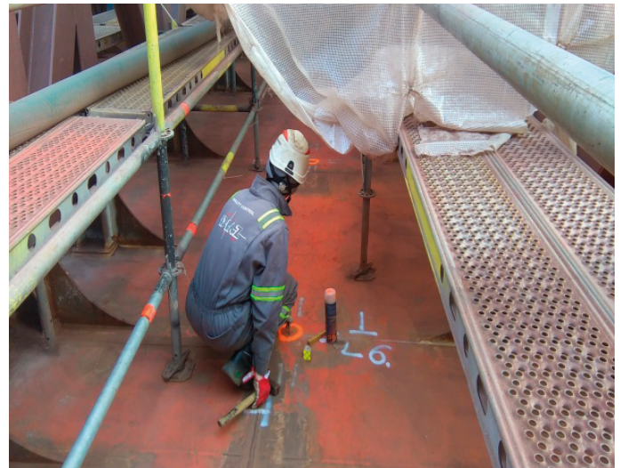
Rys. 4. Tarczki foliowe (tzw. znaczki celownicze) stosowane jako punkty pomiarowe podczas budowy kadłubów statków
