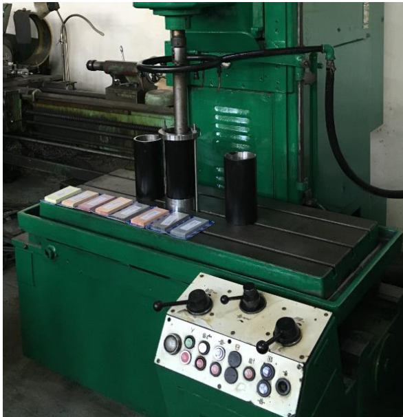
Rys. 23 Stanowisko badawcze: honownica konwencjonalna hydrauliczna WMW SZS 200
