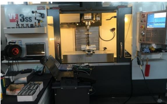
Rys. 13 Frezarka CNC HAAS VF 3SS ze sterowaniem Fanuc z oprzyrządowaniem do gładzenia f-my Honingtec
