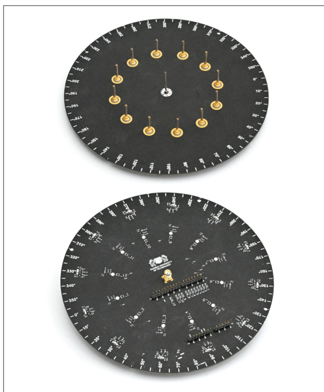
■ Rys. 3. Wytworzony prototyp (górną i dół) anteny typu ESPAR przeznaczony do integracji wewnątrz stacji bazowej pracującej w systemie Bluetooth Low Energy
