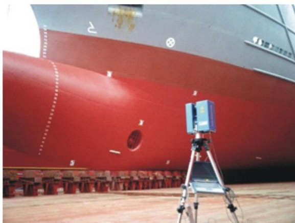
Rys. 5. Pomiaru kształtu rejonu dziobowego statku: a) stanowisko skanera [3], b) uzyskany obraz
