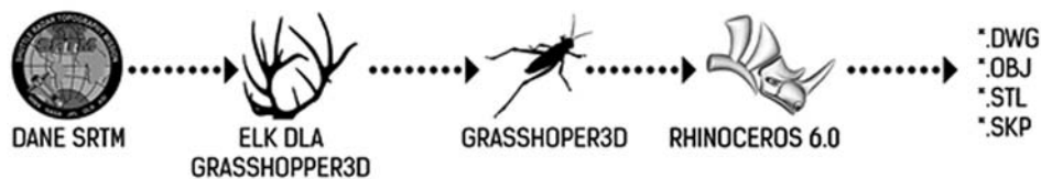
Ryc. 1. Przykład możliwości zastosowania danych SRTM w projektowaniu urbanistycznym i architektonicznym poprzez wykorzystanie danych SRTM do wykonania edytowalnych map terenu
