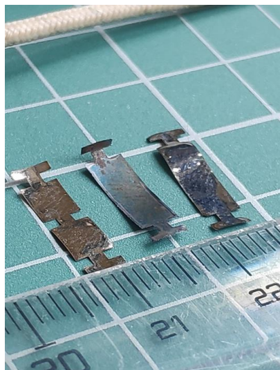
Rys. 5.8. Elektrody z folii stalowej po obróbce laserem światłowodowym
