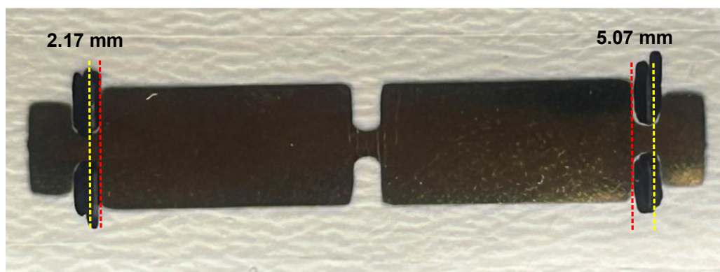
Rys. 6.3. Niesymetryczność spoin na brzegach siłownika
