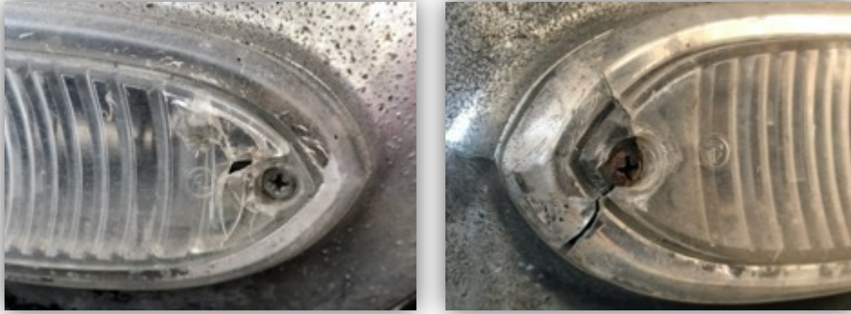
Rys. C.6. Uszkodzone klosze – usterka nr 4.2 (ŚWIATŁA, WYPOSAŻENIE ELEKTRYCZNE / Przednie, tylne i boczne światła pozycyjne, światła obrysowe / przełączniki świateł)
