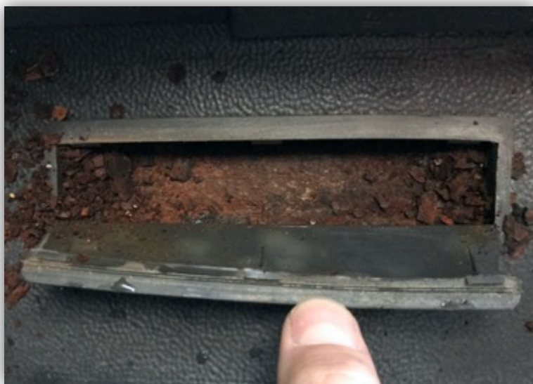
Rys. 2.17. Skorodowany numer identyfikacyjny pojazdu
