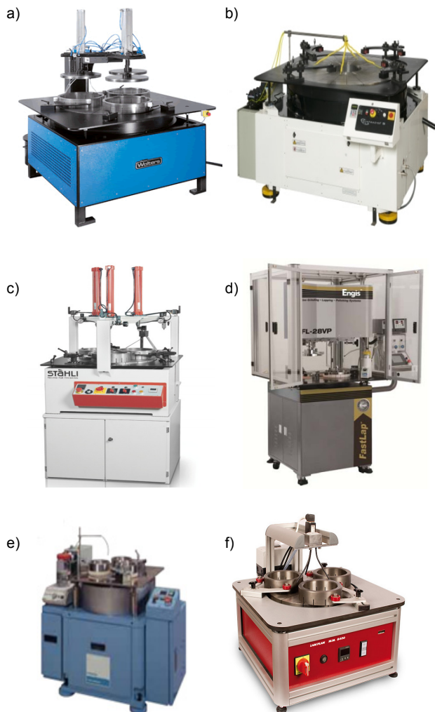
Rys. 1. Przykłady aktualnie produkowanych docierarek jednotarczowych firmy: a) Peter Wolters 3R-1200 [13], b) Lapmaster 56 OF [14], c) Stähli FLM-750 [15], d) Engis FL-28V [16], e) Hamai HS360 [17], f) LamPlan M.M.8400 [18]
