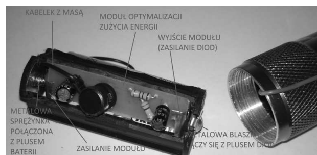
Rys. 2. Fotografia modułu zasilającego na bazie przetwornicy MCP1640
