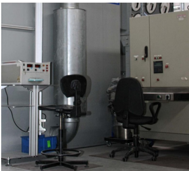
Rys. 5. Stanowisko do selekcjonowania warystorów wraz z generatorem udarów prostokątnych
