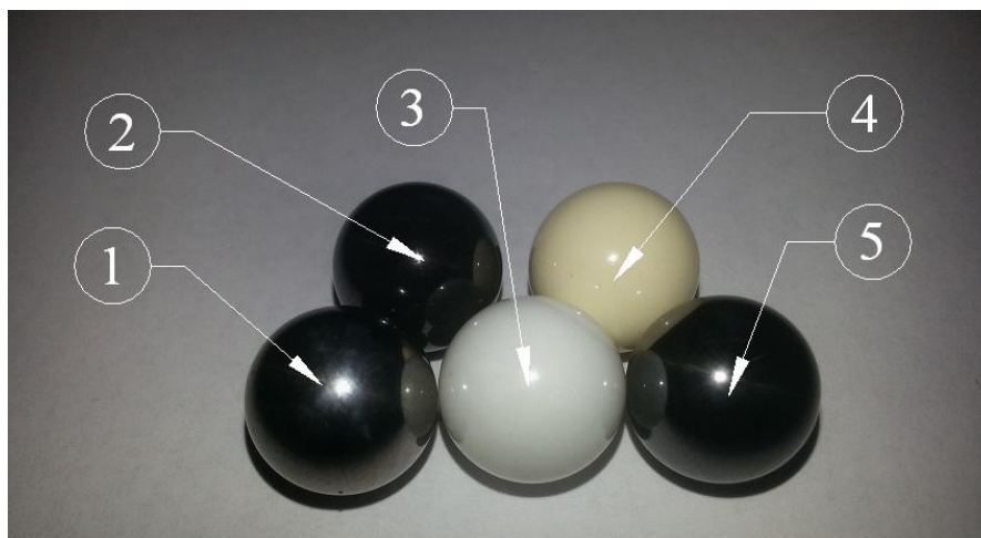
Rys. 2. Kulki ceramiczne: 1- WC, 2- Si_3N_4 , 3- ZrO_2 , 4- Al_2O_3 , 5- SiC
