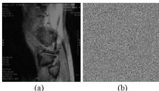
Rys. 30. Deszyfracja błędnym kluczem przeprowadzona dla algorytmu F-QFC: (a) obraz oryginalny, (b) obraz odszyfrowany przy zastosowaniu innego klucza rundowego (różnica na 1 bicie względem klucza oryginalnego).
