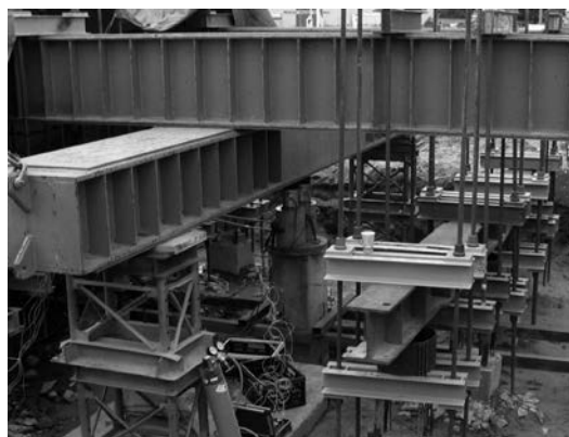
Rys. 2. Zdjęcia z próbnych obciążeń pali prefabrykowanych
