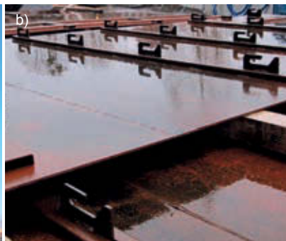
Rys. 9. Przykład zastosowania okładziny ze stali typu Cor-Ten, o podwyższonej odporności na warunki atmosferyczne, na budynku ECS w Gdańsku: a) fragment elewacji budynku, b) składowana blacha elewacyjna z widocznymi zawieszami
