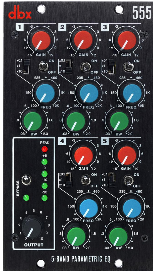
Rysunek 2-8 Zdjęcie płyty czołowej przykładowego korektora parametrycznego [84]
